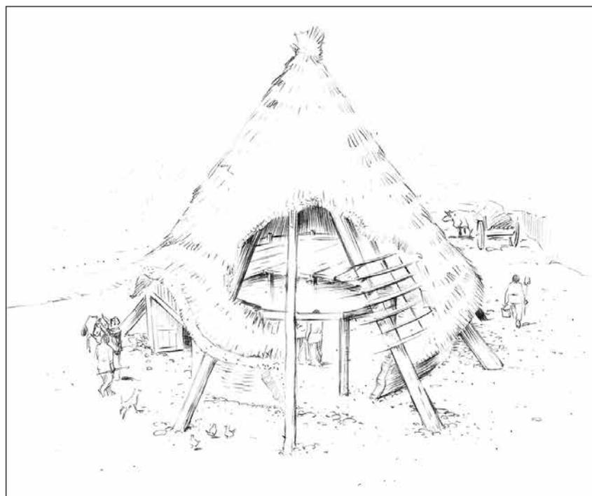
Figure 18 – Restitution d'une charpente d'édifice circulaire à partir des indices architecturaux de Cahagnes. Réal. Emmanuel Saint, graphiste-illustrateur indépendant.
