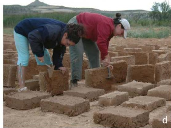
Fig. 3- Phases d'élaboration des adobes : préparation de la pâte (a) dans des récipients ou (b) dans une dépression du terrain ; (c) moulage des briques de terre crue ; (d) préparation des adobes au séchage partiel.
